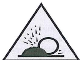
**Situazioni di pericolo:** Ogni volta che si transita o si lavora nelle vicinanze di macchine o attrezzature con organi meccanici in movimento, per la sagomatura di materiali (flessibile, sega circolare, scalpelli, martelli demolitori, ecc.) o durante le fasi di demolizione (ristrutturazioni, esecuzione di tracce nei muri, ecc.). In tutte le fasi di lavoro su rocce e costoni rocciosi.
