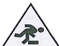
**Situazioni di pericolo :** Presenza di materiali vari, cavi elettrici e scavi aperti durante spostamenti in cantiere. Perdita di equilibrio durante la movimentazione dei carichi, anche per la irregolarità dei percorsi. I percorsi per la movimentazione dei carichi ed il dislocamento dei depositi dovranno essere scelti in modo da evitare quanto più possibile le interferenze con zone in cui si trovano persone.
