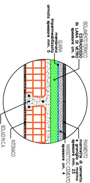
ISOLAMENTO TERMICO IN ESTRADOSSO DI COPERTURA PIANA A TERRAZZA CON LANA DI VETRO spessore cm. 6, con membrana impermeabilizzante in bitume con strato di bitume ornato con velo vetro e con film di polipropilene spessore 8 cm
